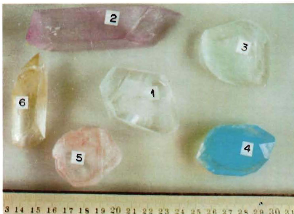
Fig. 1-a. 1. Pure TGS 2. TGS + \text{Cr}^{3+} 3. TGS + \text{Ni}^{2+} 4. TGS + \text{Cu}^{2+} 5. TGS + \text{Co}^{2+} 6. TGS + \text{Fe}^{3+}
